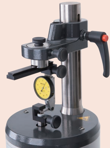
Mérőórák kalibrálása (Karos típus) opcionális tartozékokkal
