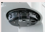
Revolverfej 2 behatolótesttel és 4 objektívvel
