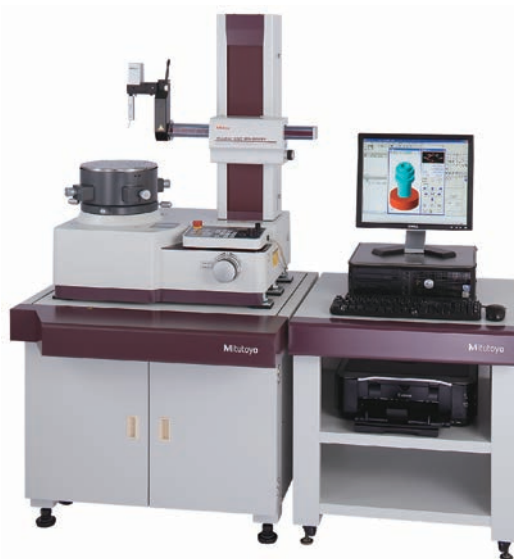
RA-2200 CNC + rezgésszigetelő asztallal [12AAK110] és oldalsó asztal [12AAL019]
