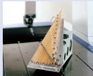
Mérőgép kalibrálása közel zérus hőtágulású üvegtalonnal
