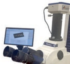
Invenio digitális kamera (63AAA058) 0.5x C-mount adapter (63AAA067) a fejlettebb megfigyeléshez.
